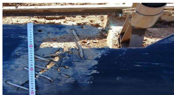
1-rasm. Tasmali konveyerning tasmasiga turli mexanik ta'sirlar oqibatida yuzaga kelgan yoriqlar ko'rinishi
