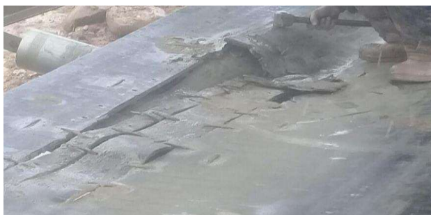
1-rasm. Tasmali konveyerning tasmasiga turli mexanik ta'sirlar oqibatida yuzaga kelgan yoriqlar ko'rinishi
