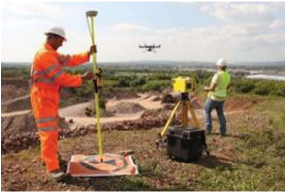
Рис. 1. Приборы (Электронные тахеометры, БПЛА (аэрофотосъёмка) GNSS-наблюдения)
