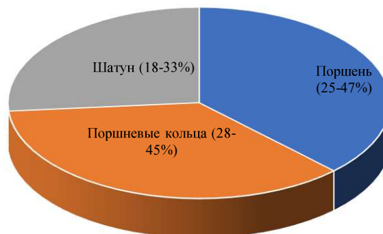
Рис. 5. Распределение мощности потерь на трение в системе силового цилиндра
