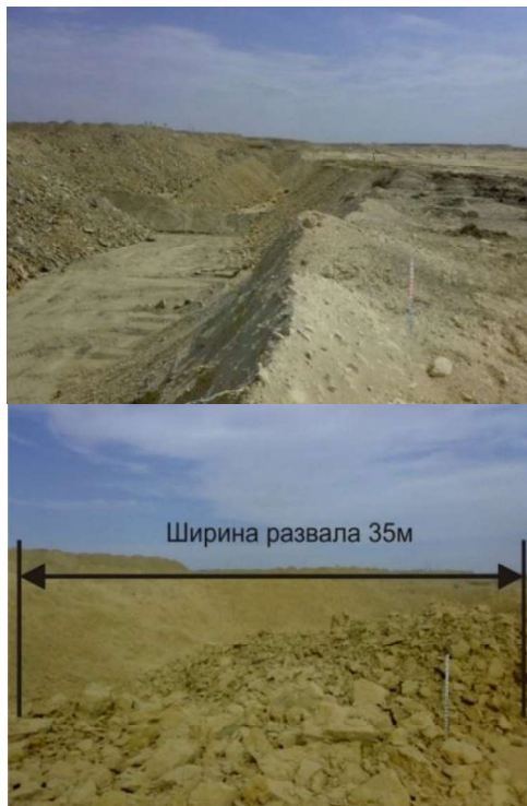
Рис. 4. Результаты промышленного взрыва при использовании базового способа
