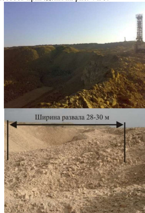
Рис. 5. Результаты промышленного взрыва при использовании разработанного способа
