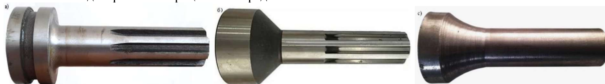
Рис.3. Общий вид поршневого ударника пневматических перфораторов: а) ПП-63, б) УТ-29, в) Предлагаемый поршень-ударник, выполненный в виде полукатеноида
