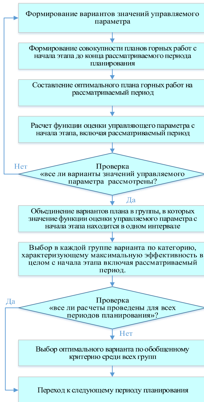
Рисунок 3. Блок-схема динамического планирования горных работ
