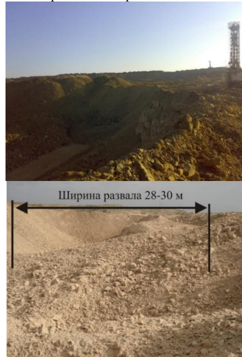
Рис. 5. Результаты промышленного взрыва при использовании разработанного способа
